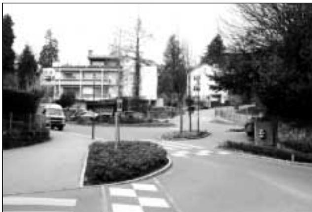
*Fig. 3: Nouvelle conception architectonique de l'entrée dans une zone «30 km/h» en ville de Lucerne. Un rétrécissement, un rehaussement de la chaussée et la disposition de bacs à fleurs attirent l'attention du conducteur sur la nouvelle vitesse maximale.*
