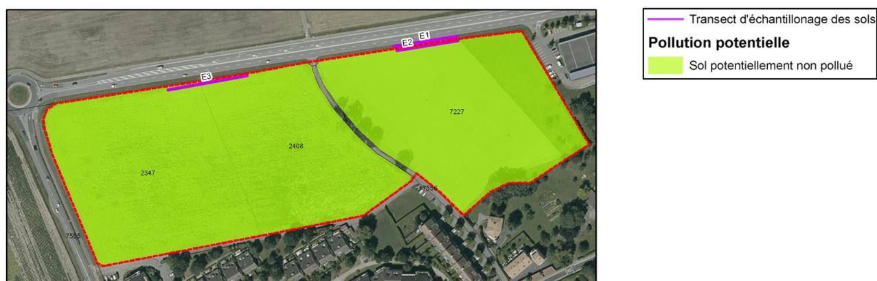
L'ensemble des échantillons a été prélevé dans les 20 premiers cm du sol en place, conformément au manuel « Prélèvement et préparation des échantillons de sols » de l'OFEV. Le résultat des analyses au sens de l'OSol effectuées par le laboratoire SCITEC SA sur les 3 échantillons analysés est résumé ci-dessous :
